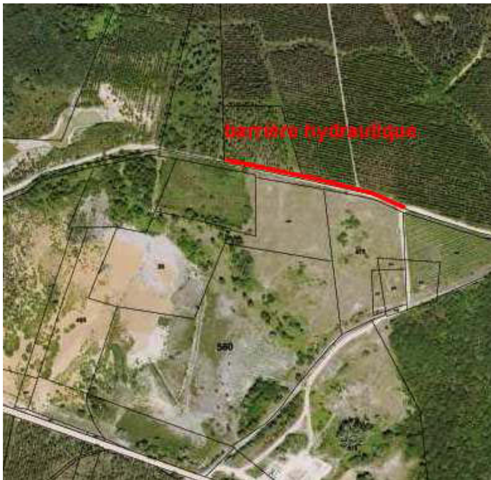
Figure 3 : positionnement de la barrière hydraulique amont (cliché aérien-cadastre)
